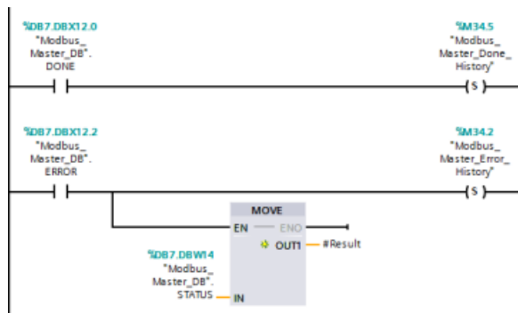
Segmento 5: impostazione di un bit di cronologia DONE al termine della scrittura. Se si verifica un errore, il programma imposta un bit di cronologia e salva il codice STATUS.
